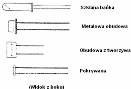
Rys. 4-3-2 Różne wykonania fotorezystorów
