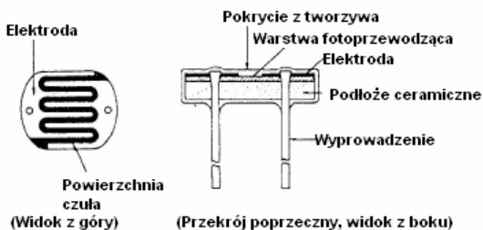
Rys. 4-3-1 Budowa przewodnościowej komórki fotoelektrycznej (fotorezystora)
